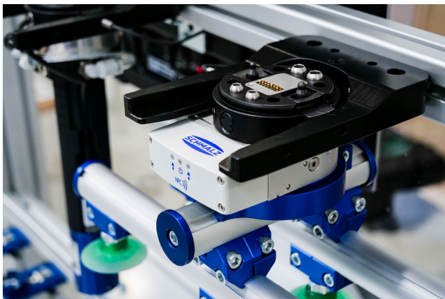
Générateur de vide pneumatique RECB MATCH lors de la manipulation d'emballages en carton
